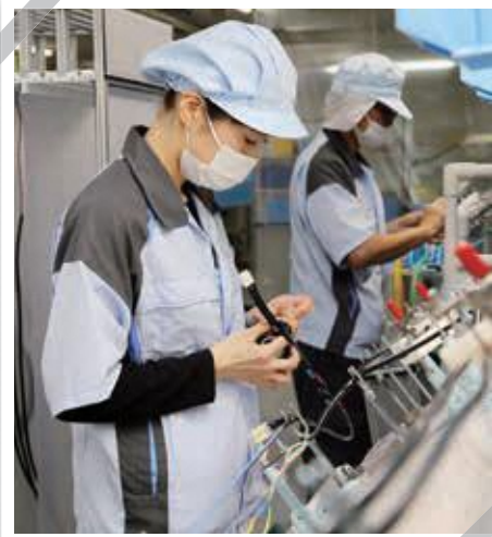
設計図に従って、さまざまな種類の電線や端子を束ねてテープで巻く作業では、正確さとスピードが求められます。
