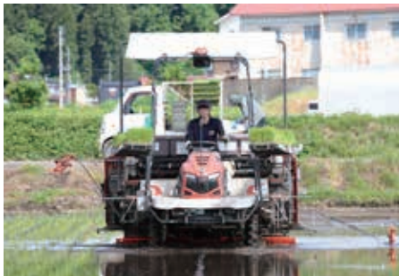
田植え機にはセンサーが搭載されており、自車の位置を把握しながら作業を行う
