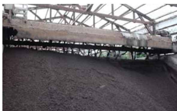
直線型ロータリー式かくはん機。原料のかくはん、混合を行い発酵を促進します
