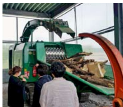
クローラー自走式切削チップ製造機械 (北海道下川町視察)
