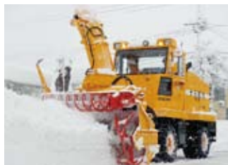
道路確保に活躍するロータリ除雪車
