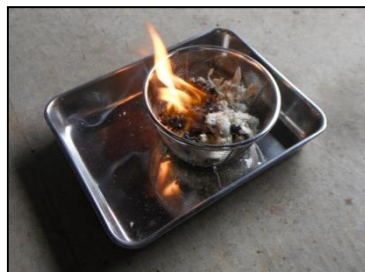
図 11：製造したフラフとペレットを燃焼
