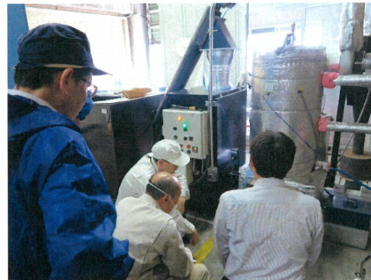
混合ペレットのボイラー燃焼試験 （紙おむつ6：木くず2：シュレッダ2）
