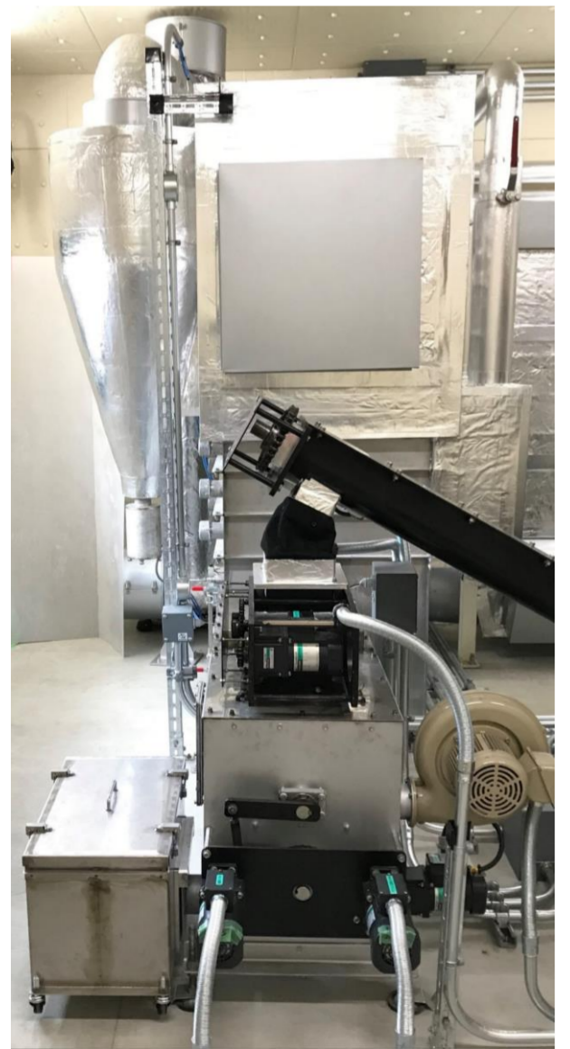
② バイオマスボイラー
