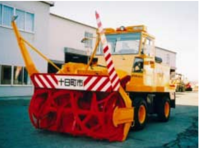
松代地域に配備されたロータリ除雪車
