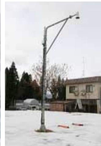
最新の超音波積雪深計
