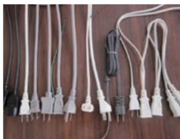
創業は平成10年。テレビの電源コードなどを生産していましたが、現在は電化製品のほか電動工具用など多種多様な電源コードを中心に生産しています。電源コードを生産している事業所は県内でも2～3社しかありません。電源コードの生産工程は、「電線の切断」「先端の皮むき」「差し込み刃の圧着」「プラグの射出成型」「通電検査」となり、月に約30万本を県外メーカーに直送しています。プラグは自社所有のオリジナル金型が21種類あるほか、メーカー指示の金型もあり、多品種少量生産に対応しています。また細かい作業工程は手作業処理を行い、徹底した工程管理で品質の安定化、納期の厳守に努め、海外製品との差別化を図っています。女性社員が6割以上を占め、細かい作業の中心的な役割を担い、女性ならではのパワーと明るさで会社に活力を与えています。現在の社会的ニーズを反映し、医療用ベッドの電源コードや太陽光発電用中継ユニットケーブルの受注が増加しています。今後も蓄積された技術を生かした新たな製品づくりに取り組んでいきます。
