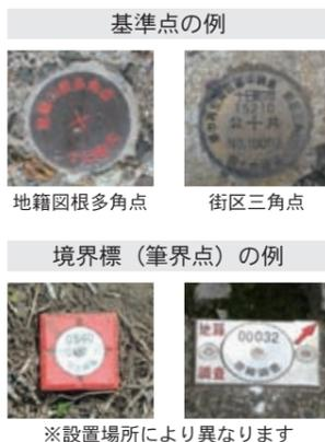
市街地には、たくさんの方の基準点が設置されています。これは土地の面積を測量するときの基になる点です。道路脇に設置されていることが多いので、工事のときに破損しないように注意してください。また、地籍調査で境界確認ができたところには杭や旗などの境界標を設置します。抜いたり移動したりしないでください（法で罰せられます）。
