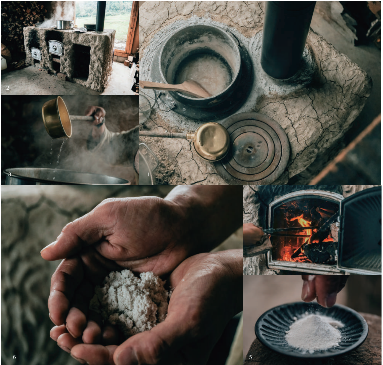
1. 煮詰めていくとキラキラした結晶が見えてくる。焦げないようにゆっくりとかき混ぜる 2. 窯職人が最後に仕上げに指で紋様を描いた塩窯は既に風格がある 3. 大きな鉄鍋から小さい鉄鍋へ煮詰まった化石海水を移していく 4. 廃材を火にくべる。炎は窯の構造で上へ上へと熱を運び、3つの鉄釜を熱する 5. 100ℓの源泉から 1500gしか塩はつくれない 5. 1200万年前の化石海水が命の塩となって目の前に現れた。かつて松之山でも塩づくりがされていたそう。6. 完成した塩を使ったスパイスやビールなどの加工品販売やコラボレーションも積極的に行う予定とのことだ。
