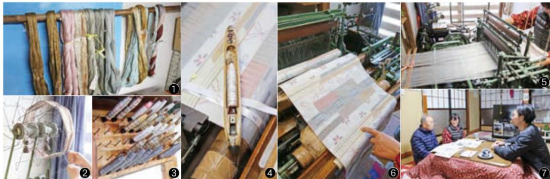
①反物の横糸になる緯糸(ヌキイト) ②③専用の機械で緯糸を管(クダ)に巻いて保管 ④シャトルに管をセットし1列ずつ織りあげていく ⑤40年以上使っている織機 ⑥反物を織っている様子 ⑦「昔は雪が降ると機屋が反を取りに来られなくて、町まで歩いて持って行くこともあったんだよ」と、当時の苦労話…
