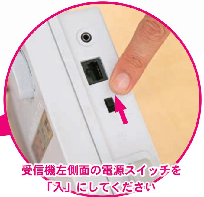
受信機左側面の電源スイッチを「入」にしてください
