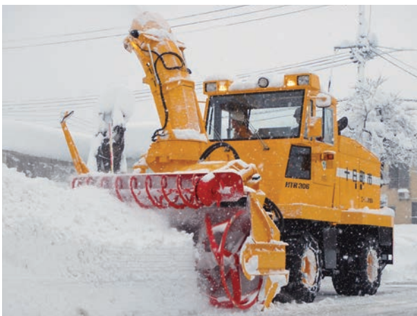
ロータリー除雪車による除雪
