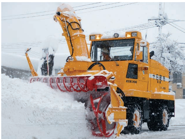
ロータリー除雪車による除雪
