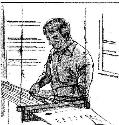
程 き(緋どめ)—染色及び糊付、 経緋のくびり糸と平ゴムをほぐ 台でさき、図案をみながらコマ、 用して緋巻台で柄合せを行い、 取る。
